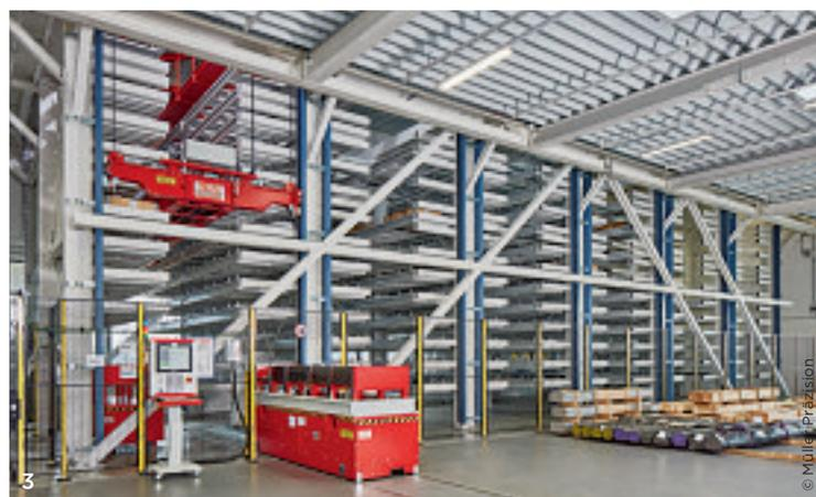
1 Seitenansicht des Lagersystems von Trafö mit Auslagerwagen und Lagerverwaltungssystem. 2 Das Herzstück des Trafö-Lagersystems: Das oben fahrende Regalbediengerät kann zwei Regalzeilen innerhalb einer Gasse bedienen. 3 Gesamtansicht des Lagersystems mit dem Regalbediengerät, das gleichzeitig zwei Regalzeilen bedienen kann.
